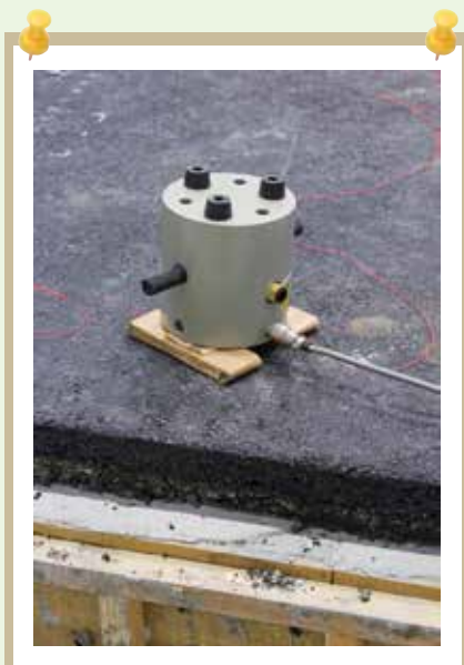
安価で取扱いが簡単、さまざまな部位・部材・構造の点検が可能、といった特長を有する「小型起振機(portable shaker)」。
