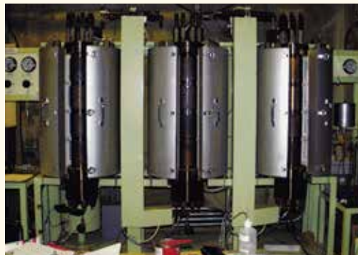
オリジナルの流通式水熱実験装置
