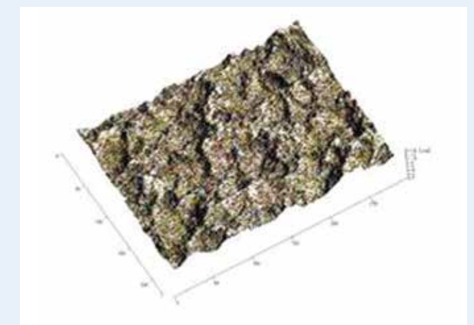
従来技術では、鋼球などをぶつけるので表面が凸凹
