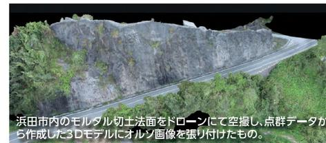
浜田市内のモルタル切土法面をドローンにて空撮し、点群データから作成した3Dモデルにオルソ画像を張り付けたもの。
