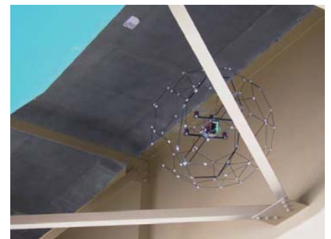
橋梁の桁間に入り点検するドローン (直径0.95m、重量2.5kg)
