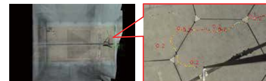
接写映像から復元した鋼橋床版の展開画像
