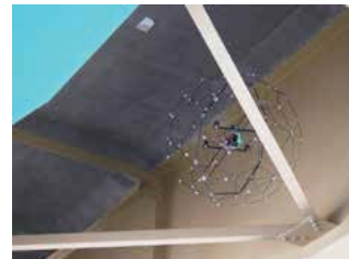
橋梁の桁間に入り点検するドローン(直径0.95m、重量2.5kg)
