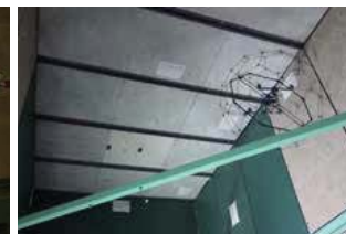
人工気象室での天候耐性試験
