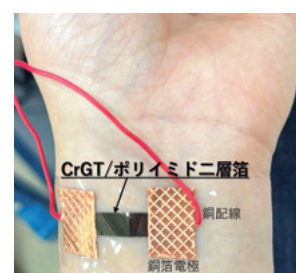
\text{Cr}_2\text{Ge}_2\text{Te}_6 薄膜/ポリイミド基板により構成される脈拍センサー
