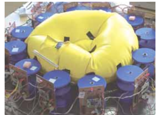
▲アメーバ様ロボットのファースト・プロトタイプSlimy。「個々の小型ロボットが刻むリズムは隣接するものにしか伝わりませんが、原形質に相当する粘弾性要素（空気が入っている黄色のゴム）を通じて伝播し、相互作用によってアメーバのような移動運動を示します。一つひとつのロボットは非常に単純な機構ですが、まさに「三人寄れば文殊の知恵」なのです」
