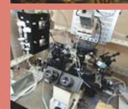
写真は、パッチクランプ法により微弱な生体電流を検出する装置。現在、全国の大学や研究機関に6台しかない、微生物生体の手づくり特許品。巨大化させた大陽歯や滑母（10μm）を用いて、生体膜にある輸送系（チャネル・トランスポーター）の分子機構にアプローチしている。この先には、動物や植物のイオンチャネルやトランスポーターの精緻な解析系としての利用が待ち構えている。
