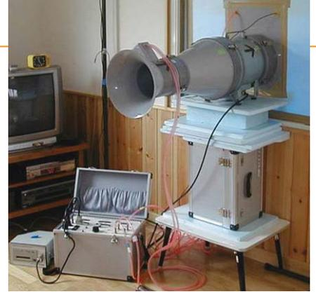
▲住宅の気密性能を測定する装置。約25年前、吉野教授のグループは国内で初めて気密性能の測定に成功した。気密性の目安となるC値(相当隙間面積、単位:cm<sup>2</sup>/m<sup>2</sup>)は、建物にどの程度隙間があるかを示す指標。数値が小さいほど気密性が高い。
