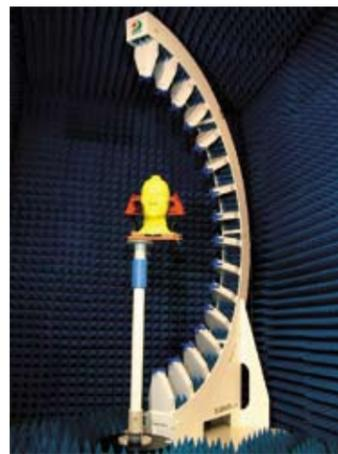
図2 電磁波の同時測定システム
