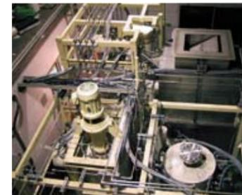
伝熱特性を評価するための溶融塩実験ループ (作動流体は HTS)
